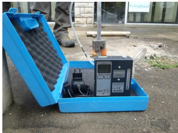
Piézaire et dispositif de pompage en place
