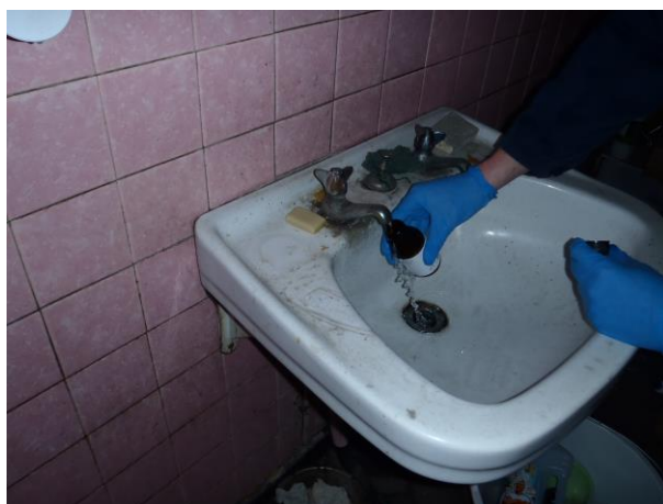
Prélèvement d'eau potable réalisé au niveau du robinet présent dans le magasin
