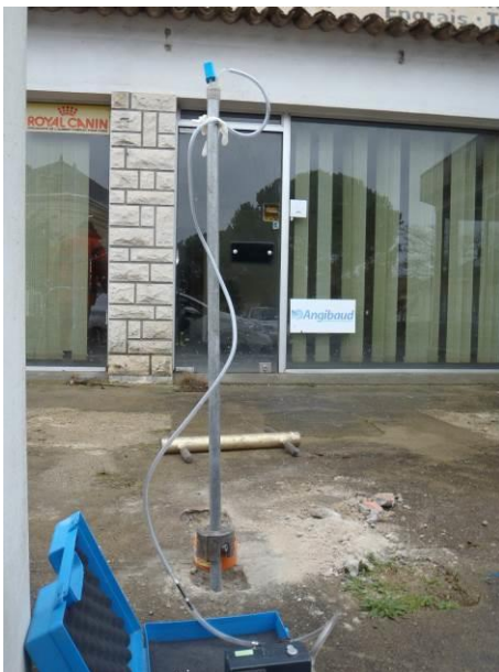
Piézaire et dispositif de pompage en place
